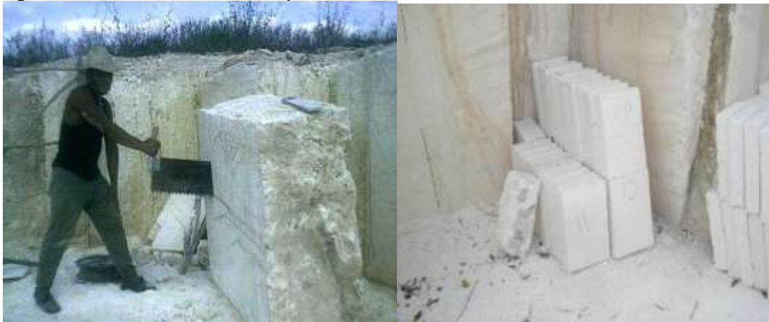
Figura 1.1: Extracción artesanal de bloques naturales
