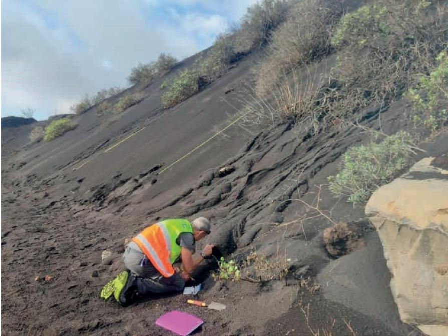
Fig. 8: Estudio de removilización de cenizas y formación de lóbulos tras lluvias intensas (La Palma)
