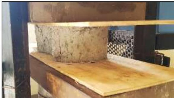
Ilustración 5: Ensayo de compresión en adoquín 5
