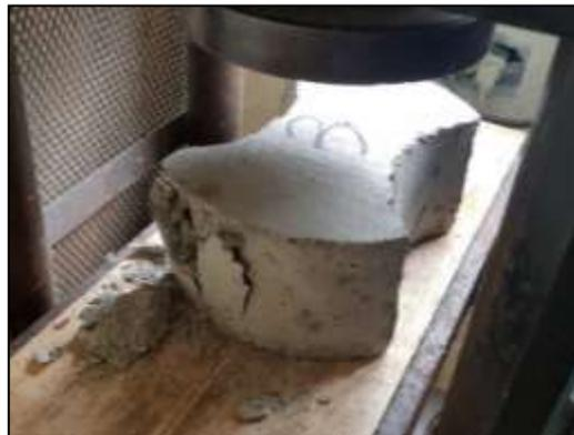
Ilustración 3: Ensayo de compresión en adoquín 3
