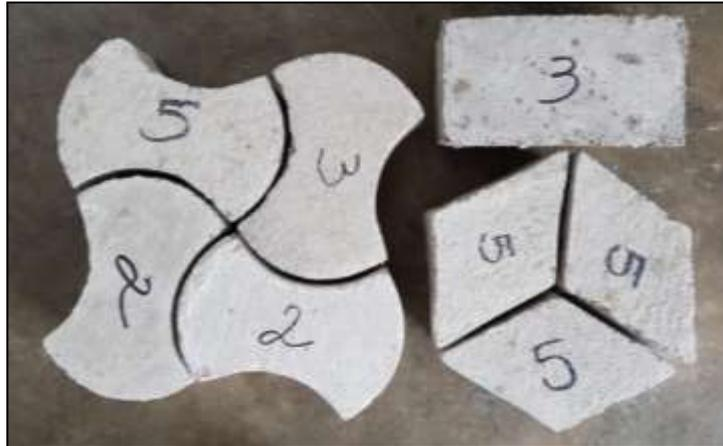
Ilustración 2: Diferentes diseños con las mezclas de los adoquines
