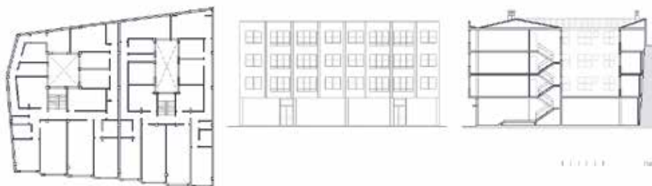
Fig.11. Planimetrías do edificio residencial en Saavedra Meneses: planta residencial tipo, alzado principal e sección transversal (reinterpretación da autora).
