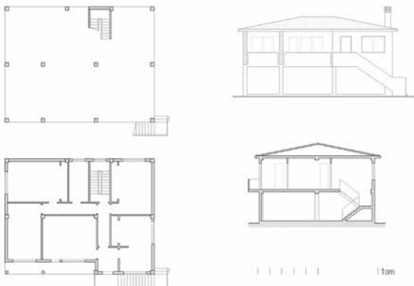
Fig.09. Planimetrías da vivenda unifamiliar no lugar de Braxe: planta baixa, planta alta, alzado principal e sección transversal (reinterpretación da autora).
