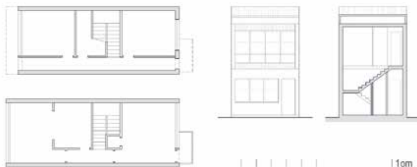
Fig.03. Planimetrías da vivenda unifamiliar en Cruz Verde n.º 29: planta baixa, planta alta, alzado principal e sección transversal (reinterpretación da autora).
