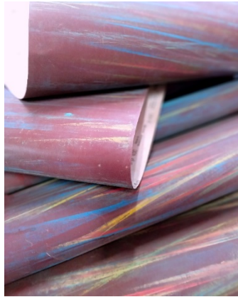
Fig. 4: Detalle del rollo de lija que revela las capas de pintura que poseía el resbalín intervenido.
