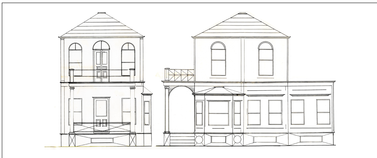
Fig. 8. Alzado frontal y lateral de vivienda de madera en dos niveles. Maestro de Obras Ramiro Gutiérrez, 1907. © Fondo de Urbanismo. Municipio Marianao. Archivo Nacional de Cuba. Cuba.
