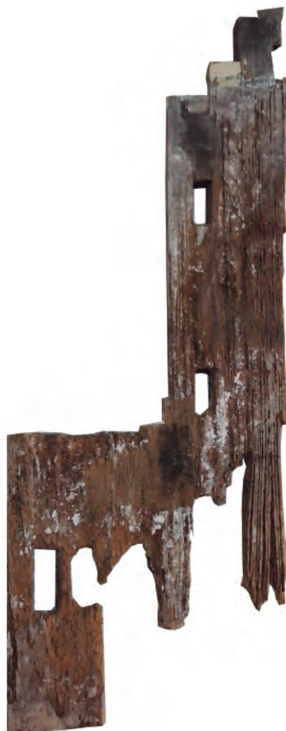
16. Madera base del retablo donde se pueden observar los mohos de coloración negra. Foto Nerea Otermin.
