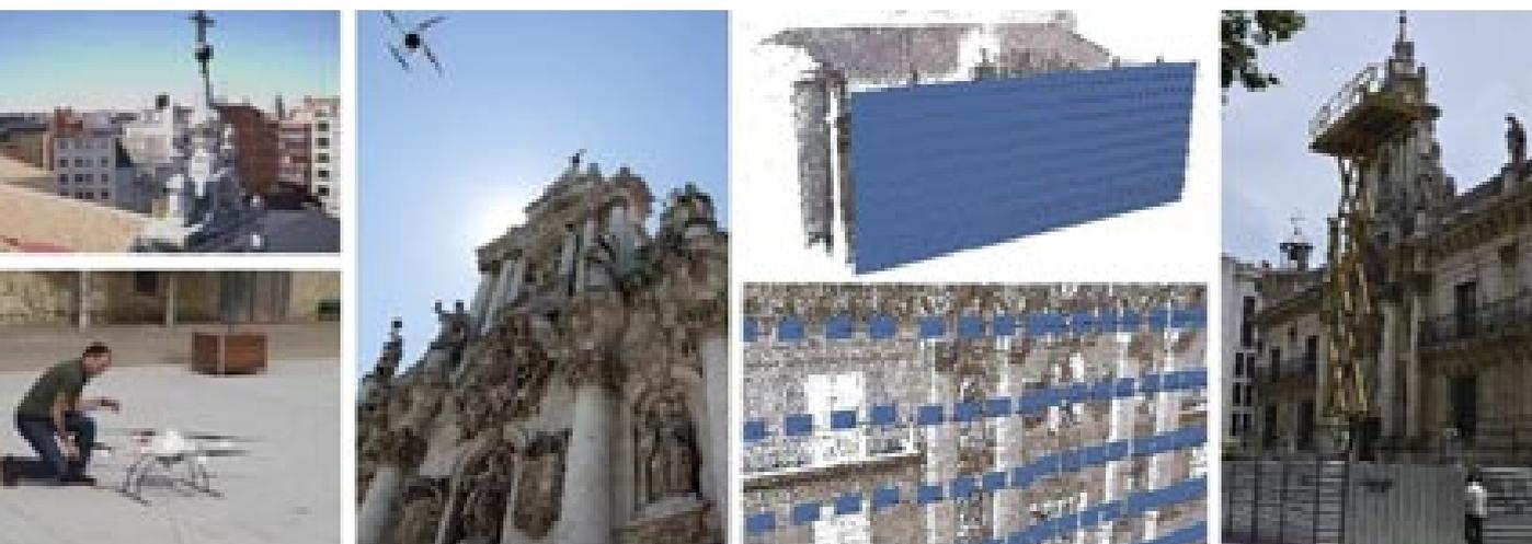
Captura de imágenes fotográficas mediante dron y elevación en altura, en la fachada de la Universidad de Valladolid.
