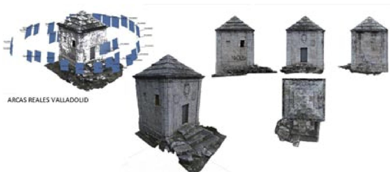
Proceso de la generación de modelos mediante fotogrametría digital para una de las Arcas Reales.
