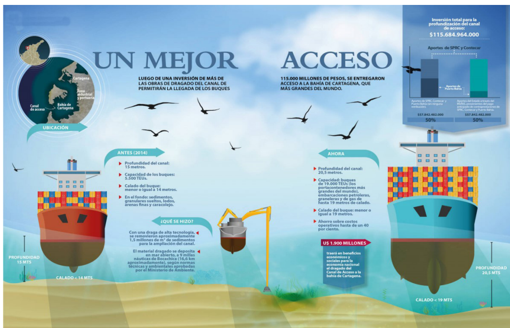
Ilustración 2. Obras de dragado del canal de acceso a la bahía de Cartagena Fuente: Obtenido de grupo puerto de Cartagena Plataforma logística y portuaria del Caribe (2015)
