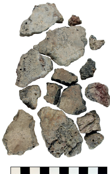
Figura 22. Fragments d'escòria de forma plana de l'UE1050, relacionades amb la reducció del ferro.
