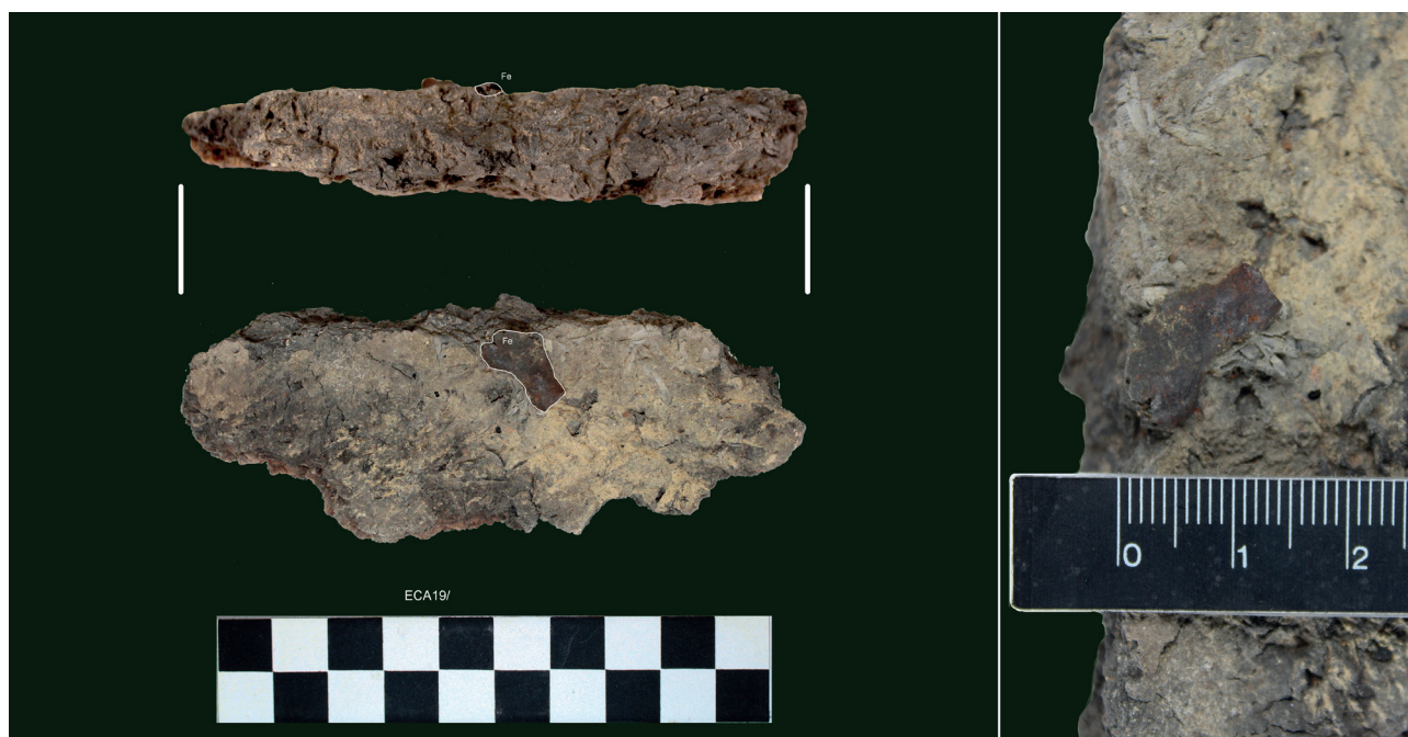
Figura 11. Fragment de paret interna de la cubeta. Foto frontal i secció. Detall de la incrustació d'escòria de ferro.
