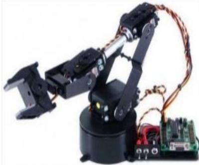
Figura 8. Módulo robótico con cinco grados de libertad
