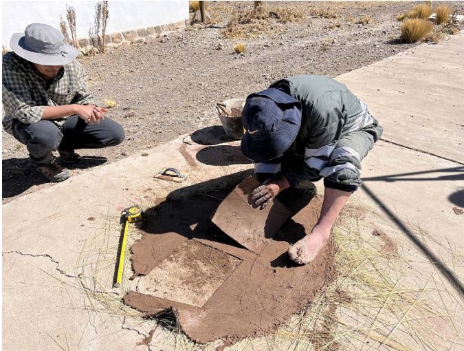
Figura 10: Cultor Aymara elaborando las probetas para ser enviadas al laboratorio. Fuente: Elaboración de los autores
