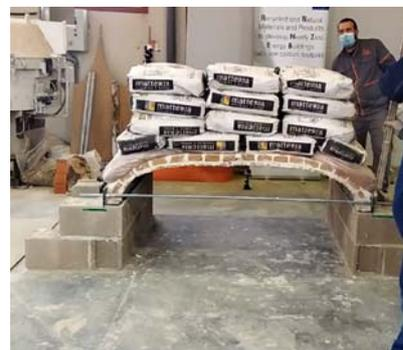
El proyecto de las viviendas de Ribera del Fresno contempla la construcción de bóvedas en dos niveles, forjado sanitario y primera planta, cada uno de ellos construidos con materiales naturales ensayados, primera hoja con vidrio celular en un caso y en otro con lana de madera, en ambos casos la segunda hoja, resistente, con bloques de tierra comprimida.
