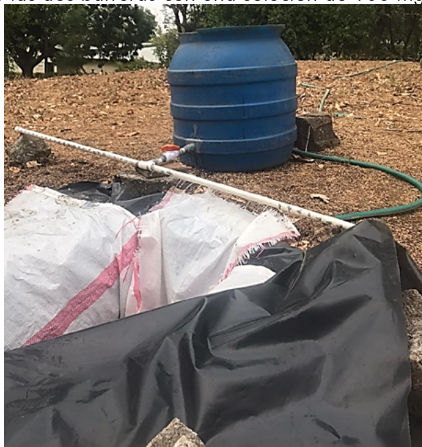
Figura 11. Sistema de simulación de escorrentía superficial agrícola alimentando las dos barreras con una solución de 100 mg/l de nitrato.
