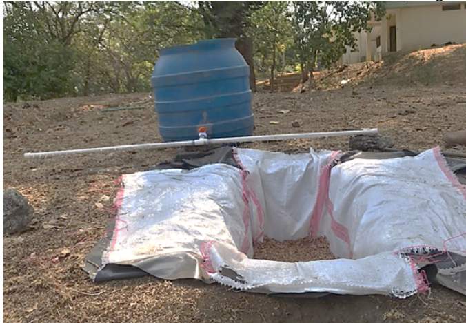
Figura 12. Vista frontal, sistema de simulación de escorrentía superficial agrícola alimentando las dos barreras con una solución de 100 mg/l de nitrato.
