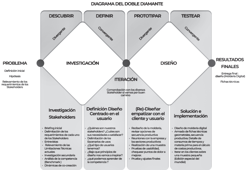
Cuadro N° 1: Diagrama del doble diamante proceso de re-diseño con la empresa Elaboración Propia.
