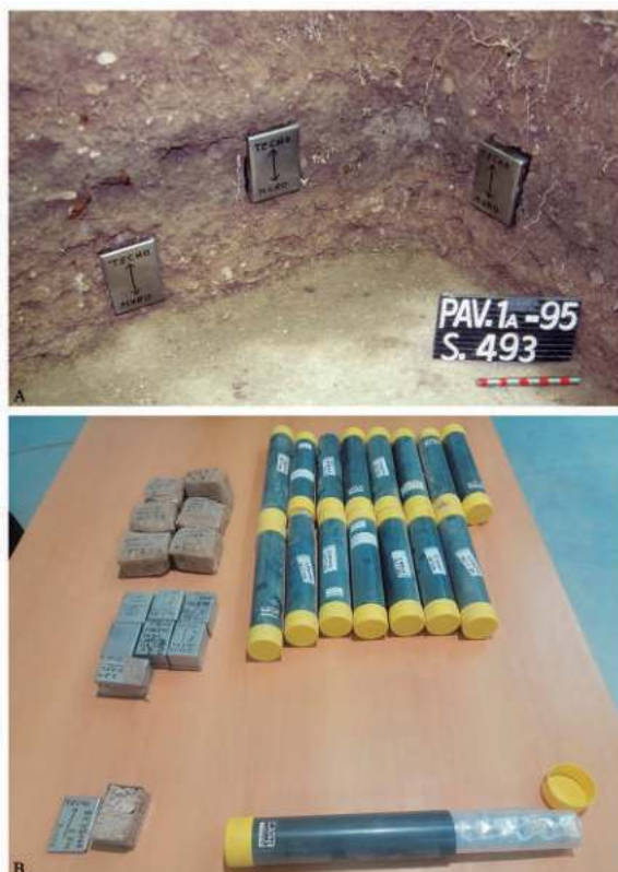
Fig. 11: Junto a las muestras estructuradas que dispensan las perforaciones cilíndricas (Fig. 9), los testigos estratigráficos son el escenario de nuevos muestreos sedimentarios. Caso de las muestras estructuradas facilitadas por las cajas Kubiena (A) o adaptaciones (B), que muestrean contextos estratigráficos concretos, a efectos de análisis sedimentarios de laboratorio. Fotografía en B facilitada por Alejandro Caballero Cobos (CIYA, Baza).
