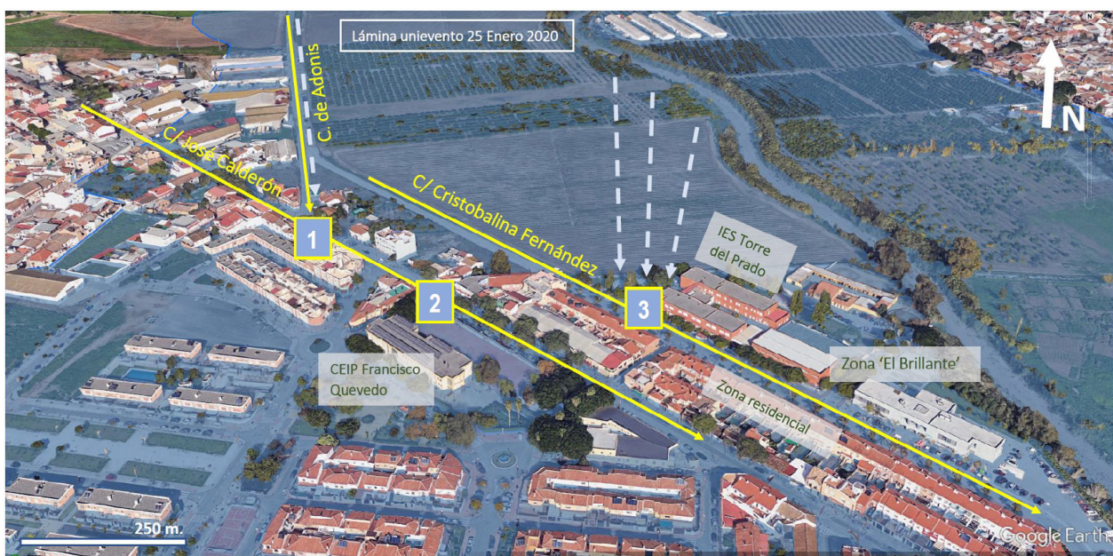
Figura 7. Recreación lámina unievento y puntos destacables de modificación del flujo por interferencias urbanas
