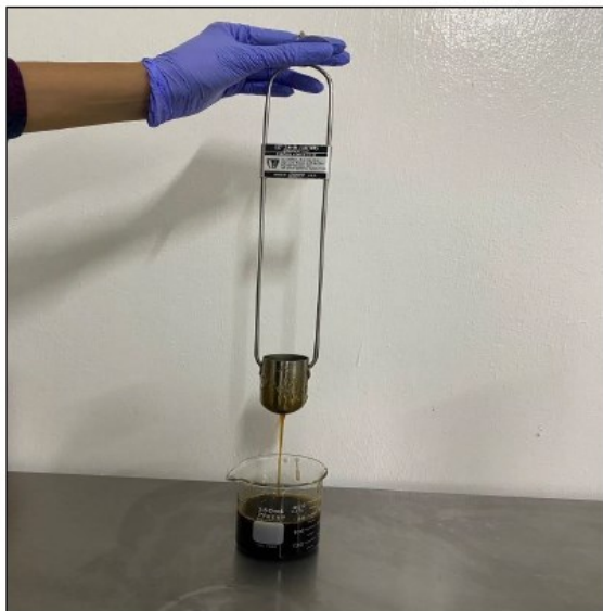
Figura 9. Medición de viscosidad con el viscosímetro de copa.
