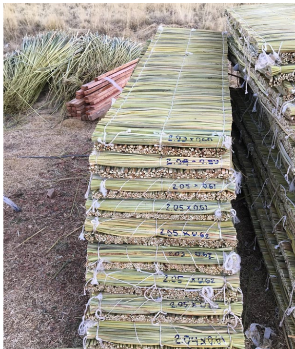
Figura 15. Paneles de totora de doble quesanas cruzadas fabricados artesanalmente.
