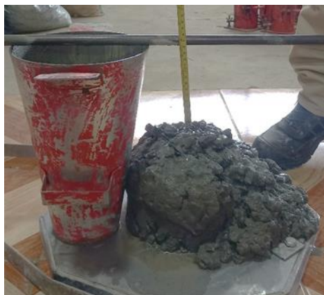
Figura 9: Revenimiento de la mezcla de hormigón
