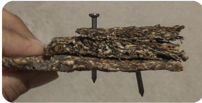
Figura 6: Teste de perfuração do material com pregos. Fonte: Autor (2021).
