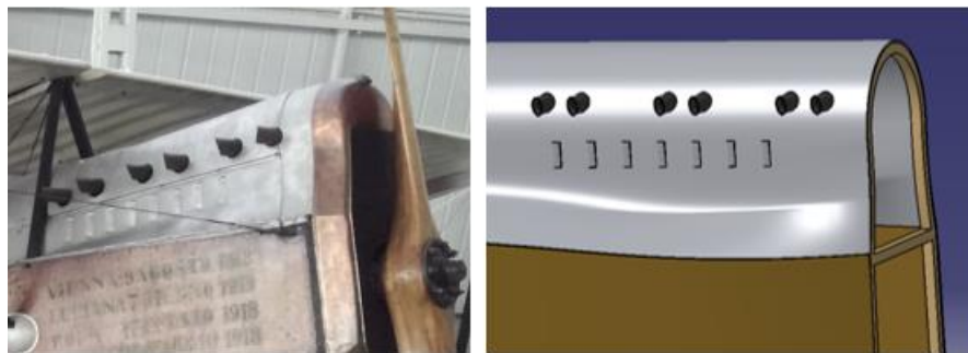
Fig. 12: Carcasa del motor real (izda.) y carcasa del motor modelada en CATIA (dcha.)
