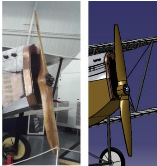
Fig. 33: Hélice real y modelo en CATIA.
