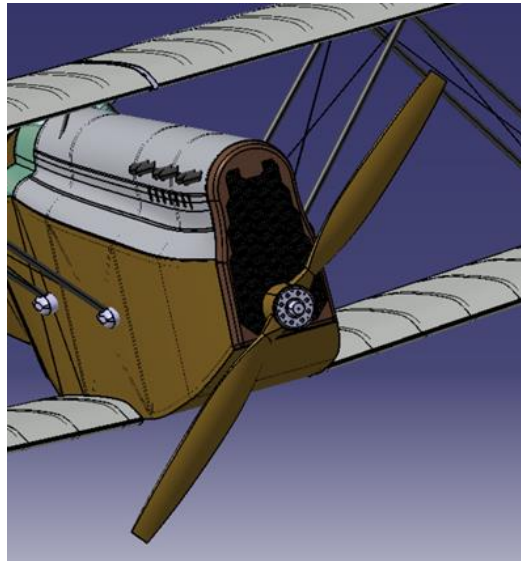
Fig. 35: Posicionamiento del conjunto de la hélice en el fuselaje.
