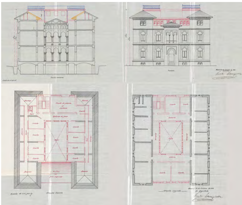
Fig. 10.- Sección transversal y alzado principal del proyecto de ampliación de Vicente Lampérez.
