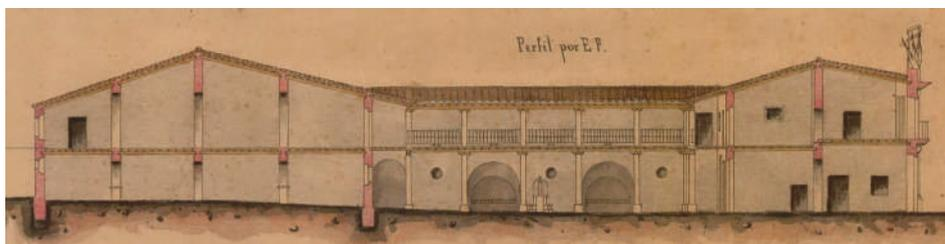
Detalle del plano del AMGM, CA-12-35 con el perfil de corte que refleja la tipología del edificio, sus cubiertas y los niveles del mismo.
