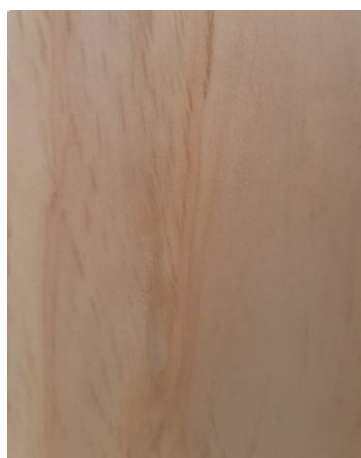
Figura 7. Resultados del lijado de la madera de A. nepalensis en corte tangencial
