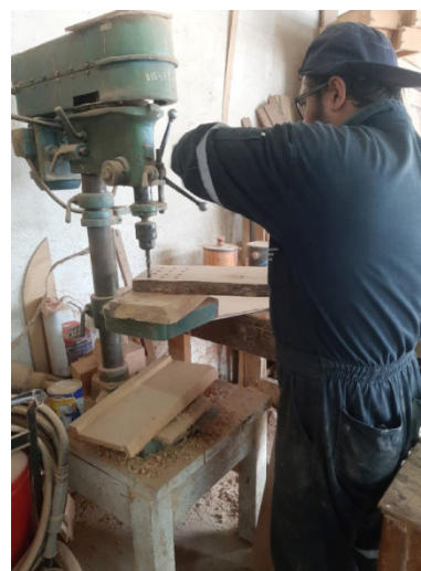
Figura 4. Prueba de trabajabilidad de taladrado
