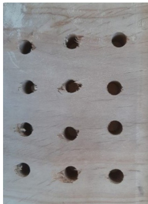
Figura 8. Aspecto de la madera de A. nepalensis D. Don. luego del ensayo de taladrado en la cara tangencial
