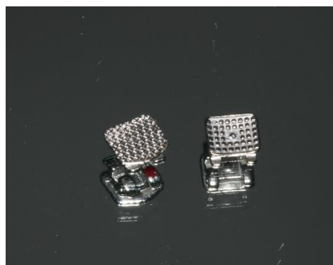
Figura 2: Bracket a la derecha con base de labrado de malla (grupo A). Bracket a la izquierda con base perforada (grupo B).
