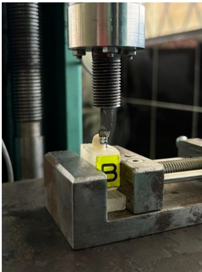
Figura 7: Fijación y estabilización de la base de acrílico con la máquina de estudios y posición de la punta biselada de acero inoxidable.
