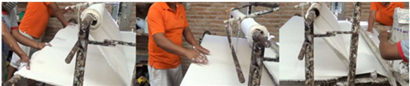
Proceso de pegado del vinil con lona
