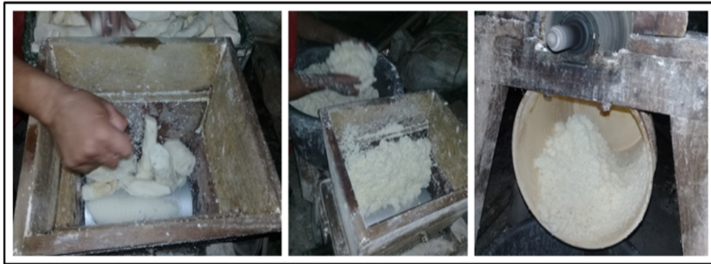
Figura 9. Rallado de la yuca y su respectiva masa depositada en el tanque.
