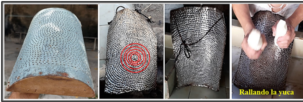
Figura 3. Estructura de la ralladora manual.
