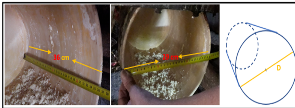
Figura 8. Medidas del cilindro.
