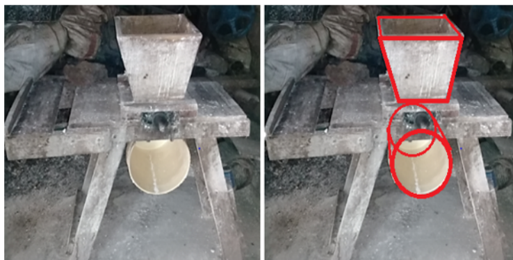
Figura 5. Recipientes que conforman la ralladora eléctrica.
