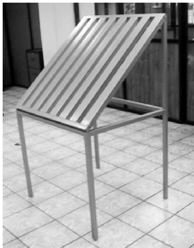
Figura 1. Racks para ensayos exteriores.
