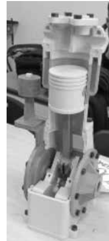
Figura 5. Ensamblaje del compresor en físico
