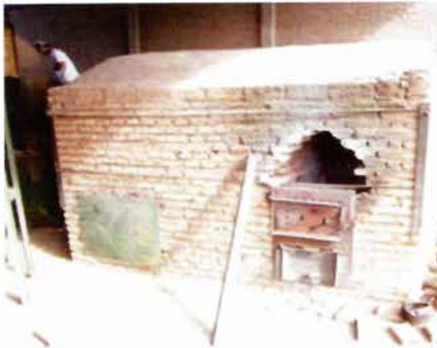
Figura 1: Horno para biomasa (leña) de secadero de industria mediana típica de la región.
