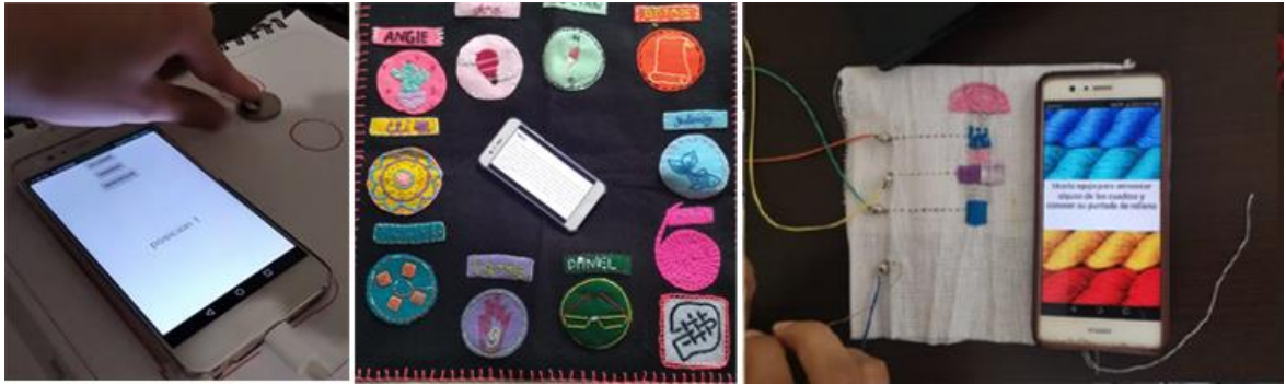
Figura 11. De izquierda a derecha. Prueba de la funcionalidad de SensorMov que permite determinar la posición de un imán. ITU donde el mensaje mostrado corresponde al parche bordado al que el celular esté apuntando. ITU para mostrar el proceso de elaboración de una puntada con una aguja imantada Fuente: [41].
