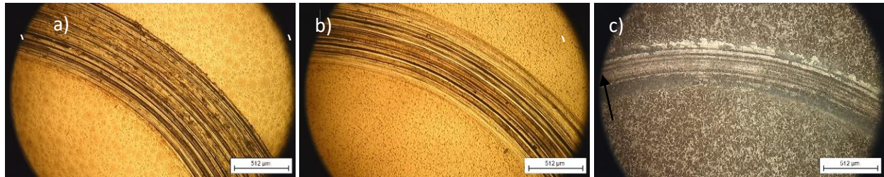
Figura 4. Imágenes de microscopía óptica de las superficies desgastadas después de las pruebas biotribológicas a 30 rpm. a) Forjada, b) EBM y c) EBM+Anodizada. Fuente: elaboración propia.
