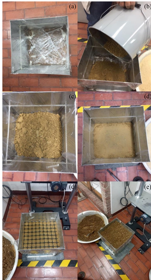
Figura 4. Construcción del modelo físico: a) protección de la caja metálica; b) colocación la subrasante; c) compactación de la primera capa de subrasante; d) compactación subrasante; e) colocación de la geomalla; f) colocación del material de mejoramiento.
