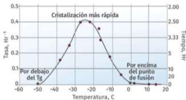
Figura 2: Relación generalizada entre temperatura y tasa de cristalización
