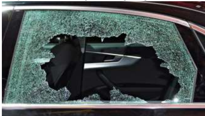
Figura 9: Vidrio de seguridad templado para automotores
