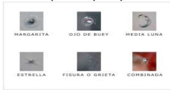
Figura 15: Tipo de fractura de parabrisas reportada por el control de calidad en auditorias
