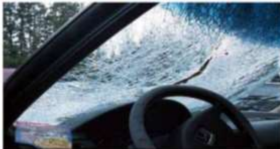
Figura 8: Vidrio de seguridad laminado para automotores
