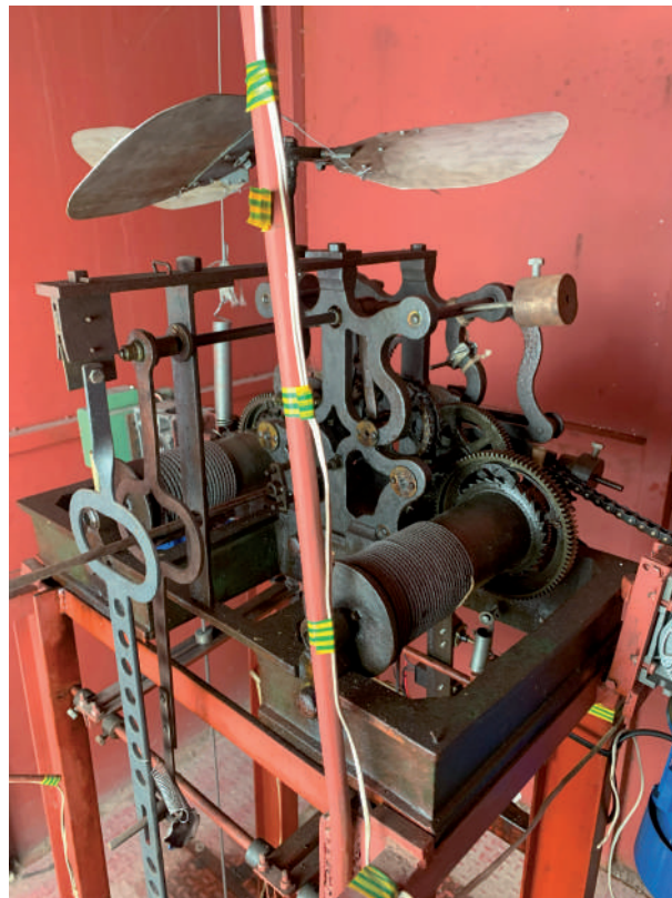
Fig. 12. Parte posterior de la maquinaria de Castrillo-Tejeriego, situada en la iglesia. Se aprecia que varias piezas del mecanismo son de moderna factura al igual que el cableado y adaptación de los elementos eléctricos que, si bien resuelven la funcionalidad práctica, afectan negativamente a la estética. Fotografía: 19/04/2023.
