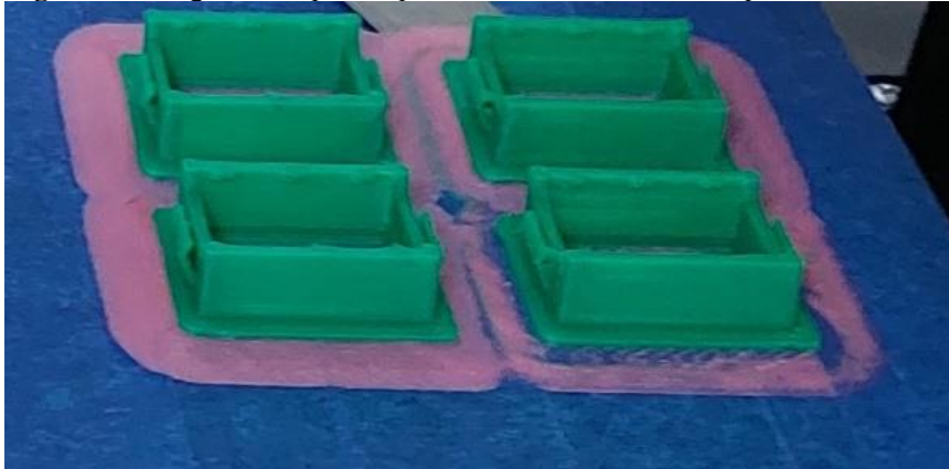
Figura 5. Imagen de soportes para voltímetro realizados por sistema de impresión 3D.
