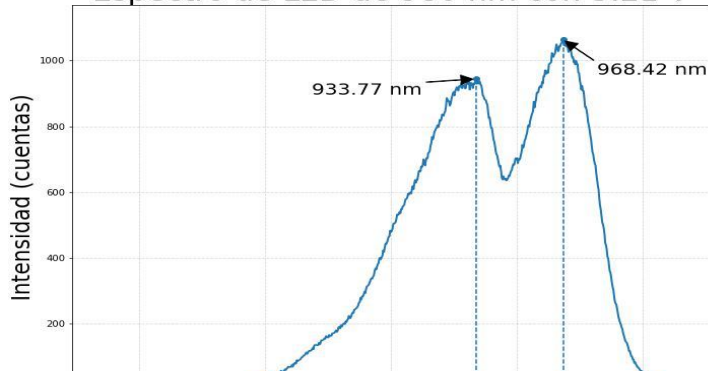
Figura 13. Espectro LED 980 nm \Delta V = 3.21 V Espectro de LED de 980 nm con 3.21 V
