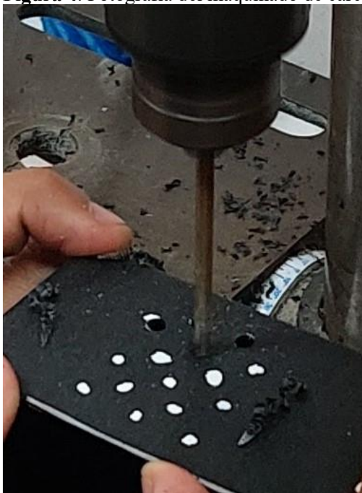
Figura 4. Fotografía del maquinado de carcasa para sistema de ventilación.
