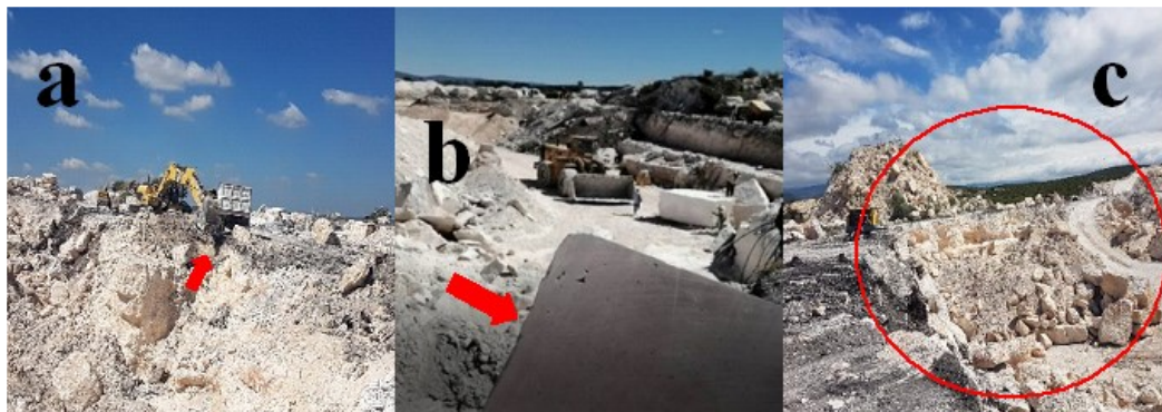
Figura 4. a) Extracción por perforación, b) extracción por hilo diamantado, c) extracción por uso de explosivos.
