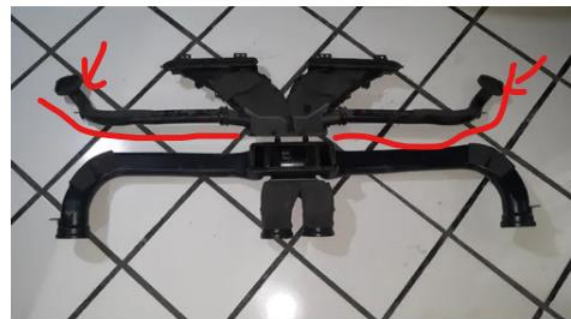
Figura 2. Partes físicas del sistema frontal de HVAC.
