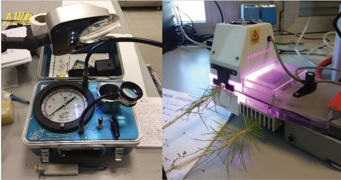
Figura 9. Cámara de presión tipo Scholander (izquierda) con el que se midió el potencial hídrico del tallo; y sistema de análisis de intercambio de gases por infrarrojos (IRGA) con una cámara adaptada a coníferas (derecha) con el que se midieron los parámetros relacionados con el intercambio de gases de las acículas de las plántulas de pino: tasa de asimilación neta de \text{CO}_2 , tasa de transpiración, conductancia estomática y concentración subestomática de \text{CO}_2 .
