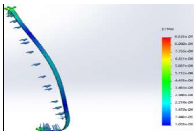
Figura 21. Deformación unitaria equivalente. Autoría Propia con apoyo de SolidWorks
