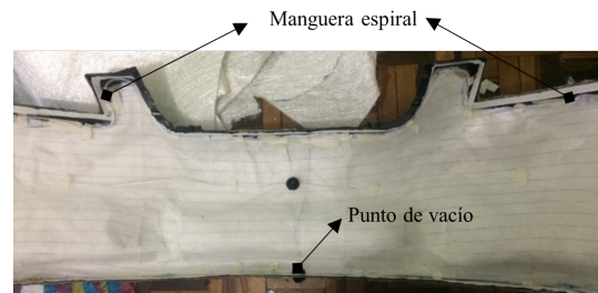
Figura 14. Ubicación de la manguera espiral y el punto de vacío utilizados para VARTM
