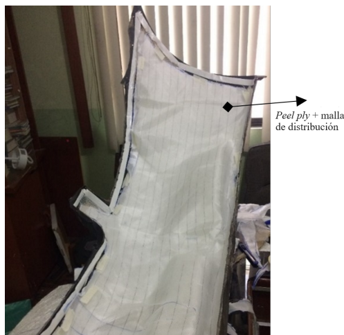
Figura 13. Peel ply y malla de distribución sobre las fibras utilizadas como refuerzo
