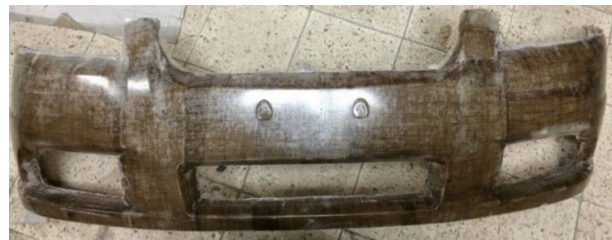
Figura 18. Vista frontal del prototipo de guardachoque obtenido mediante VARTM
