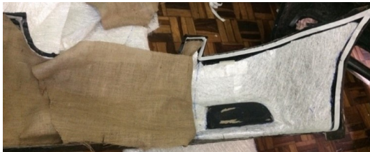
Figura 12. Disposición de las fibras de vidrio y cabuya sobre el molde
