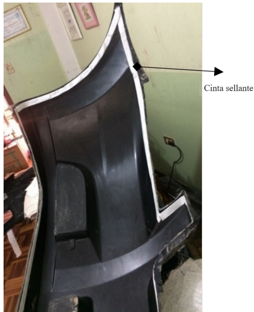
Figura 11. Colocación de la cinta sellante sobre el molde
