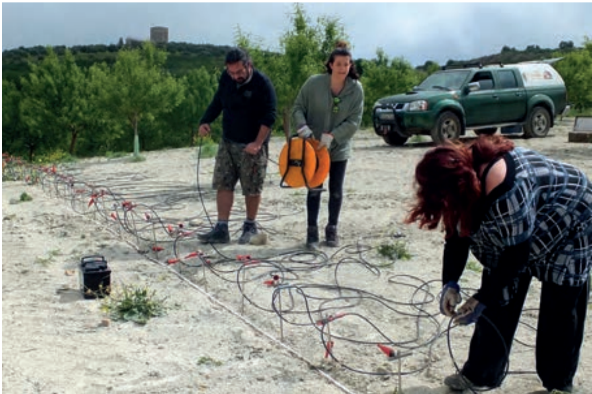
Foto 16. Preparativos de uno de los perfiles de la tomografía eléctrica.
