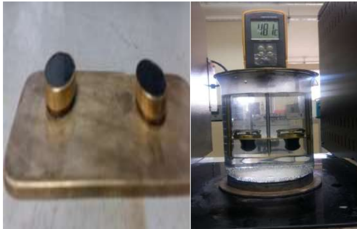
Figura 5. Equipo para prueba de ablandamiento de asfalto
