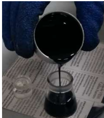
Figura 8. Realización de ensayo de densidad
