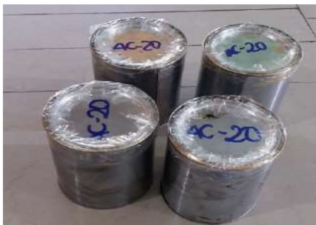
Figura 1. Recipientes de acero con muestras de asfalto convencional
