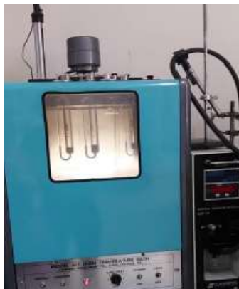
Figura 6. Equipo para medir la viscosidad del asfalto
