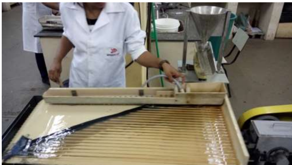
Figura 7. Teste de concentração densitária na mesa oscilatória (Elaborado pelas autoras)
