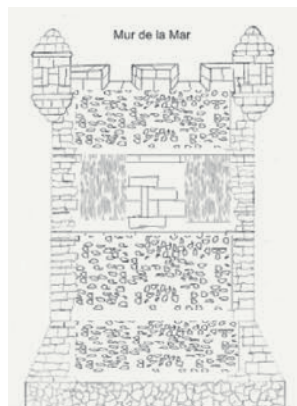
Il·lustració 4. Cara del mur de la mar de la Torre del Pinaret.
