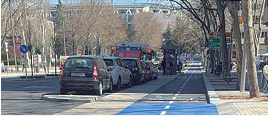
Fig. 8. Vista de la reforma de la calle General Perón, en la que la reducción de carriles de tráfico ha permitido disponer un espacio ampliado y cómodo para otros usos como las bicicletas y los VMP, la ampliación de los alcorques o la colocación de bancos y terrazas.
