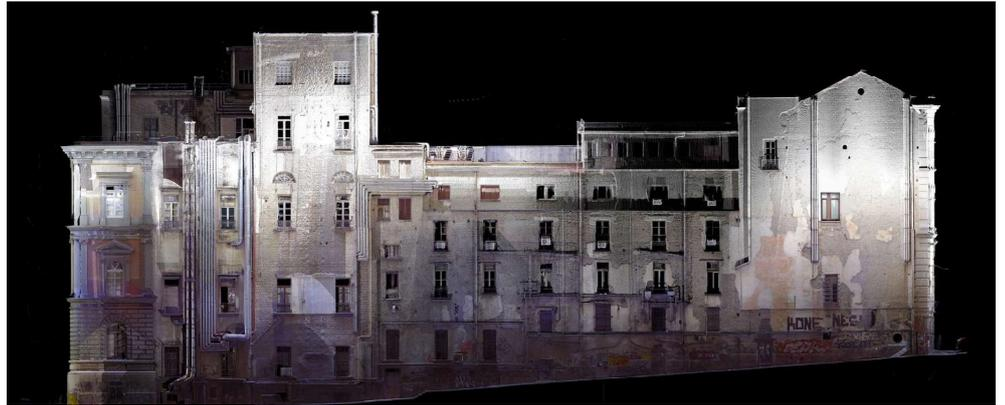
Figura 5. Levantamiento del 2018. Vista axonométrica desde el sur de la nube de puntos del estudio de modelado range-based. Imagen de los autores
