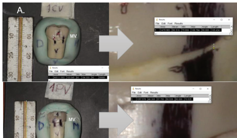
Figura 3. Obtención del ajuste marginal. Discrepancia marginal interna de la endocorona mediante el programa Imagen J del grupo de cerámica híbrida (A) y PEEK (B).
