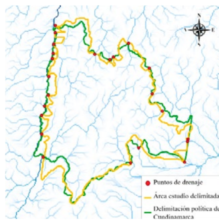
Figura 6. Área estudio delimitada a partir del ráster de acumulación de flujo y la división política del departamento de Cundinamarca.
